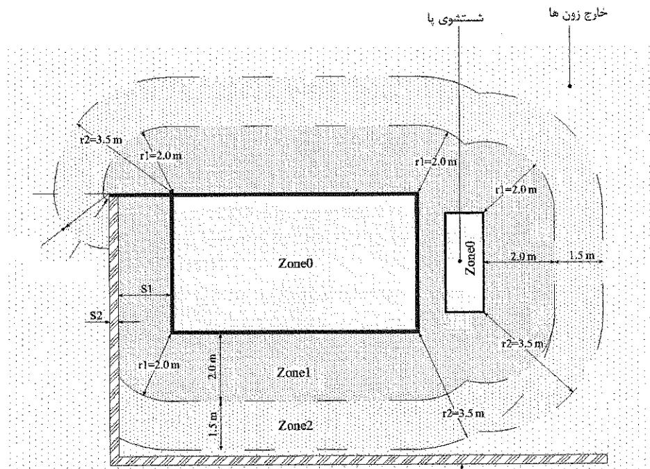
دیوار جداکننده ثابت  $S_1$  = فاصله استخراج از دیوار جداکننده ثابت
