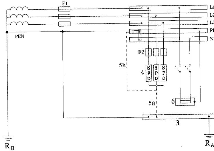
شکل ۱۳-۳-۱۶-۱: طرحواره نصب برقگیر حفاظتی در شبکه توزیع سیستم نیروی TN (سه‌فاز)
