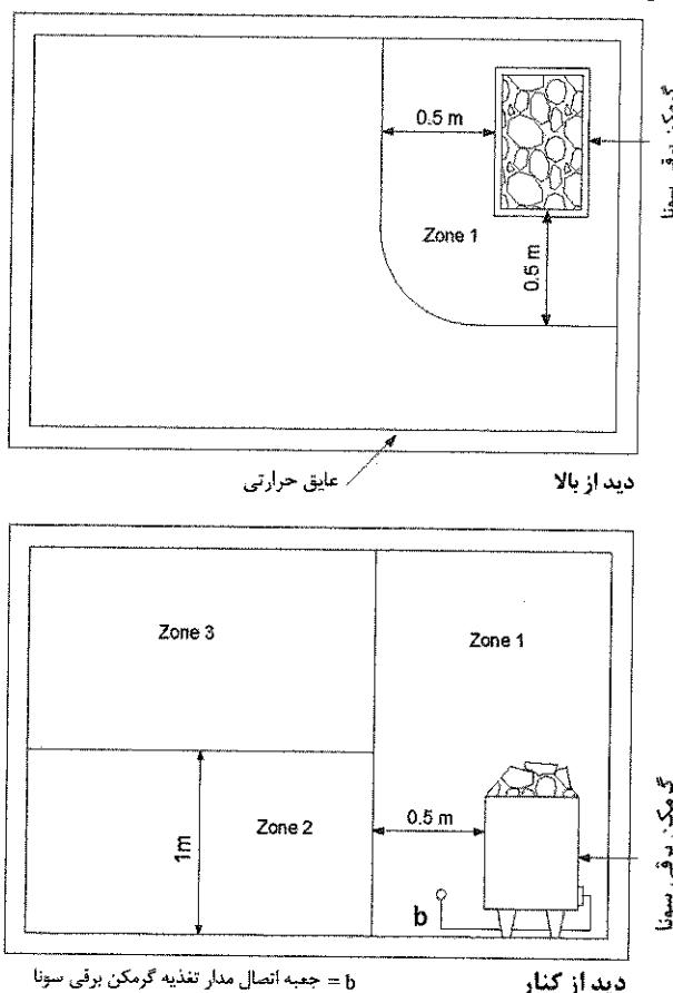
شکل ۱۰-۱۳-۶ طرح‌واره مناطق (zone) مربوط به سونا بر اساس درجه حرارت محیط آن
