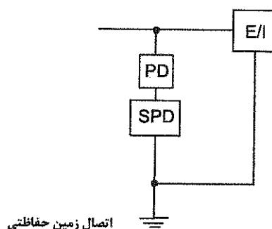
شکل ۱۳-۳-۱۶-۱-۳ طرحواره نصب وسیله حفاظتی و برقگیر حفاظتی در تابلو برق تعذیه‌کننده دستگاه و یا تجهیزات
