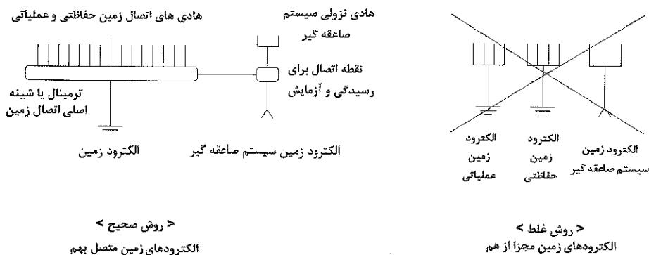
شکل پ ۱-۲-۳ طرحواره نحوه اتصال الکترودهای زمین حفاظتی، عملیاتی و صاعقه‌گیر
