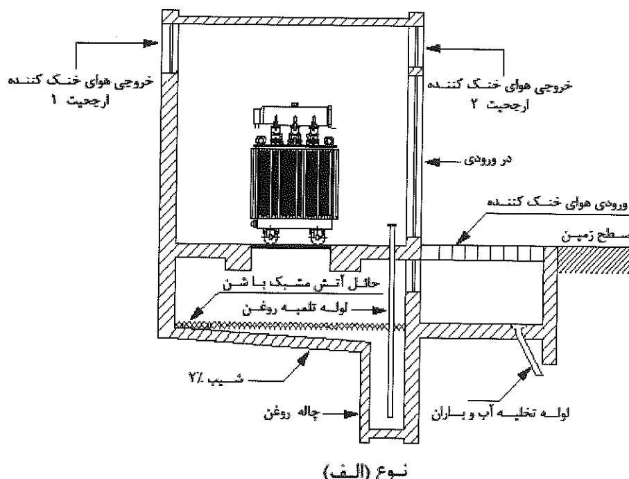
شکل ۱۳-۵-۳-۲:۳ (نوع الف) - طرحواره مقطع قائم اتاق ترانسفورماتور روغنی با تهویه مکانیکی و هم سطح زمین
