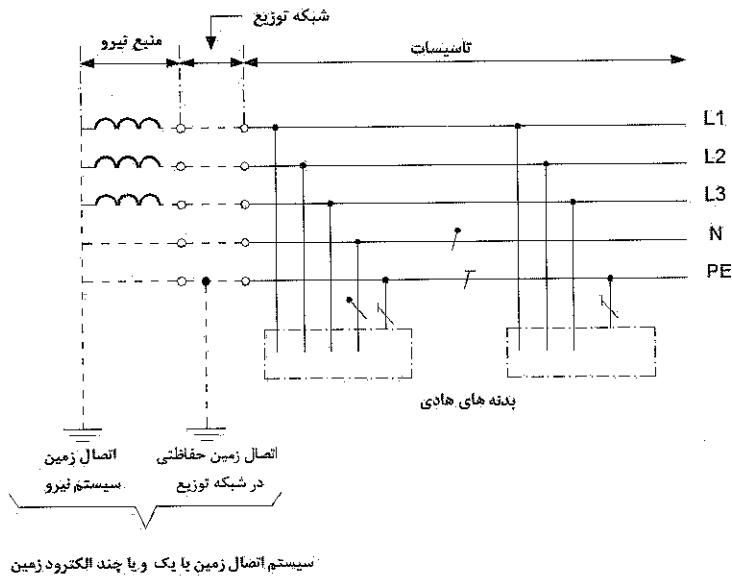
شکل پ-۱-۱-۱-۱ سیستم TN-S در سیستم سه‌فاز پنج سیمه با هادی‌های مجزای حفاظتی و خنثی در سرتاسر سیستم
