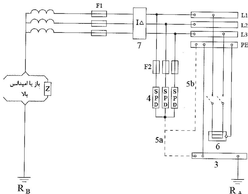
شکل ۱۳-۴-۱۶-۱-۳-۴ طرحواره نصب برقگیر حفاظتی در شبکه توزیع سیستم نیروی IT
