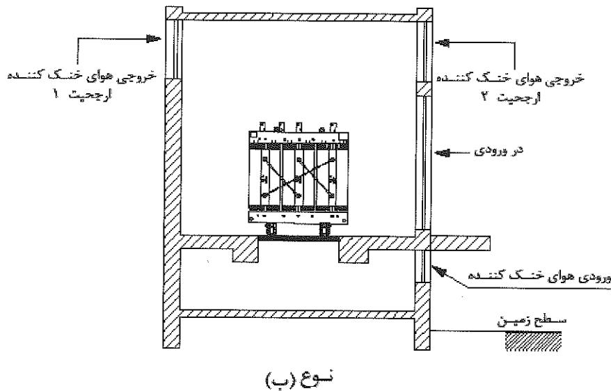
شکل ۱۳-۵-۴ (نوع ب)- طرحواره مقطع قائم اتاق ترانسفورماتور خشک با تهویه مکانیکی و بالاتر از سطح زمین
