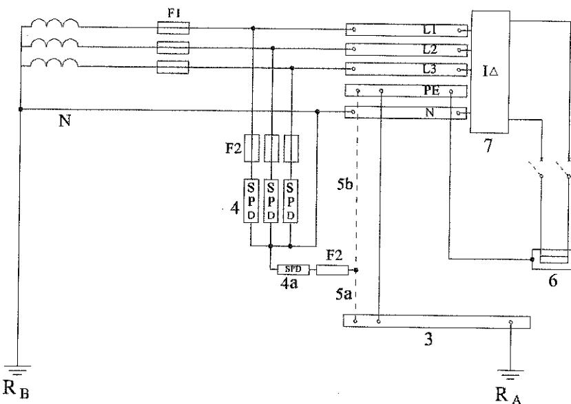
شکل ۱۳-۳-۴-۱۶-۱-۳ طرحواره نصب برقگیر حفاظتی در شبکه توزیع سیستم نیروی TT با قرارگیری برقگیر حفاظتی قبل از کلید حفاظتی جریان باقی مانده (RCD)
