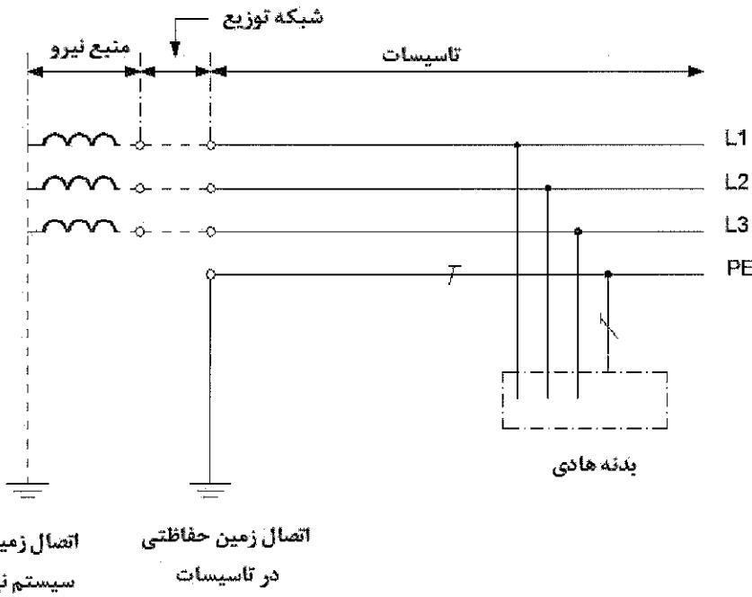
شکل پ ۱-۱۵ سیستم TT در سیستم سه‌فاز با هادی حفاظتی و بدون توزیع هادی خنثی در سرتاسر سیستم
