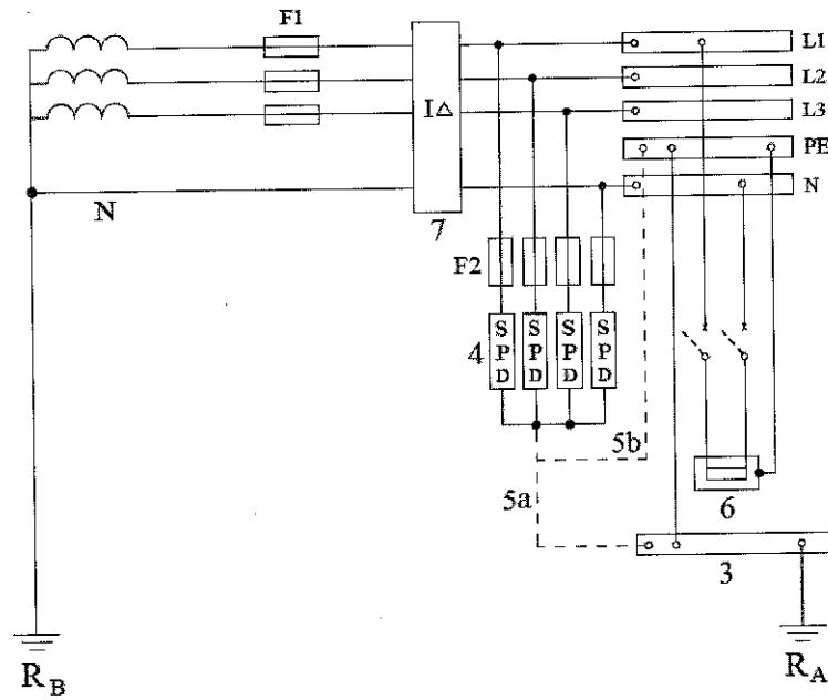
شکل ۱۳-۳-۱۶-۲: طرحواره نصب برقگیر حفاظتی در شبکه توزیع سیستم نیروی TT با قوارگیری برقگیر حفاظتی در طرف تغذیه بار و بعد از کلید حفاظتی جریان باقی‌مانده (RCD)
